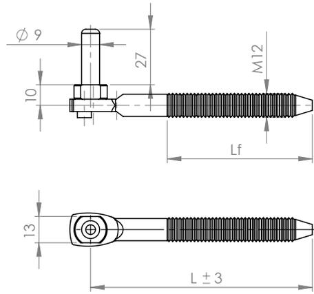
Il perno eccentrico permette la regolazione in orizzontale dell'anta ruotandolo. Per effettuare questa operazione è necessaria una chiave inglese da 13mm
