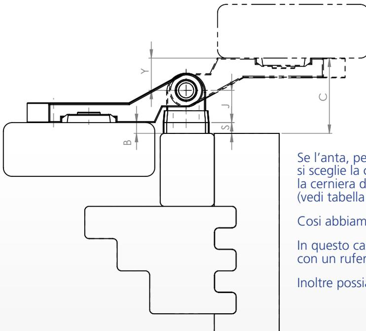
Se l'anta, per ipotesi, dovesse sormontare di 3mm ( $B=3$ ) si sceglie la cerniera a filo poiché il piano di appoggio della cerniera dista di 15mm ( $Y=15$ ) dal foro centro cardine (vedi tabella cerniere a filo).
