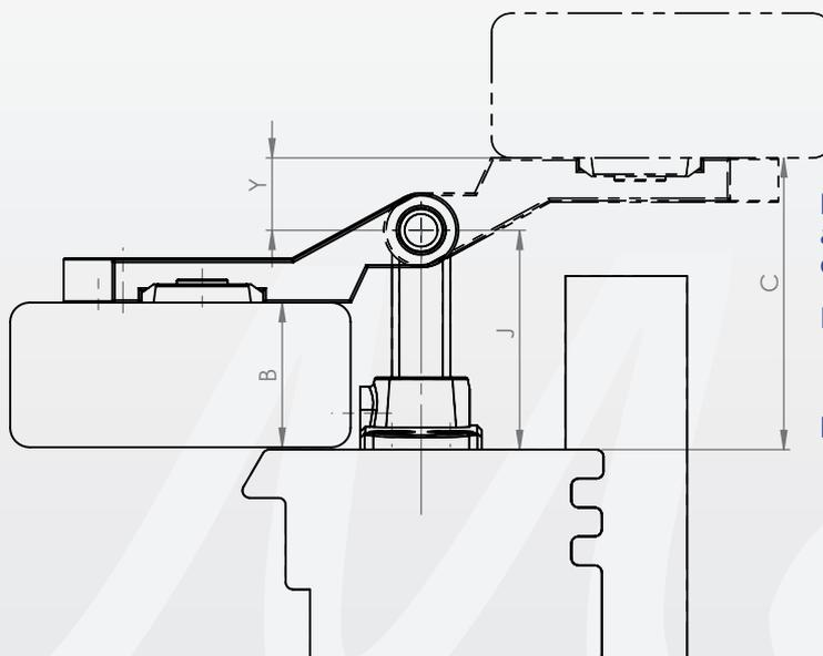
Nell'ipotesi dovessimo avere un'anta a sormonto totale ( $B=44\text{mm}$ ) con una cerniera a filo è facile risalire al valore di C.
